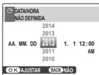
**2.1** Pressione o seletor para a esquerda ou para a direita para realçar o ano, mês, dia, hora ou minutos e pressione para cima ou para baixo para alterar. Para alterar a ordem na qual são apresentados o ano, mês e dia, realce o formato da data e pressione o seletor para cima ou para baixo.
