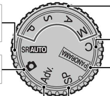
**P, S, A, M:** Seleccione o controle total sobre as definições da câmera, inclusive a abertura (**M** e **A**) e/ou a velocidade do obturador (**M** e **S**) (📖 31).
