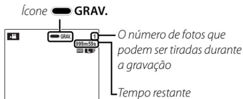
Para terminar a gravação, pressione o botão **●** de novo. A gravação termina automaticamente quando o filme atinge sua duração máxima ou quando a memória está cheia.
