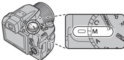
Pressione o botão para escolher entre a velocidade do obturador e a abertura e rode o disco de controle para ajustar a definição selecionada.
