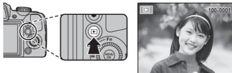
Pressione o seletor para a direita para ver as imagens na ordem em que foram gravadas e para a esquerda para ver as imagens na ordem inversa. Mantenha o seletor pressionado para ir rapidamente para a foto desejada.
