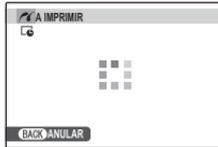
Se a impressão for interrompida, pressione **▶** para desligar a câmera e ligá-la novamente.
